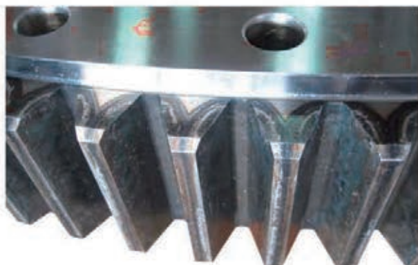
Tempra del dente fianco e fondo Gear hardening flank and root of the teeth
